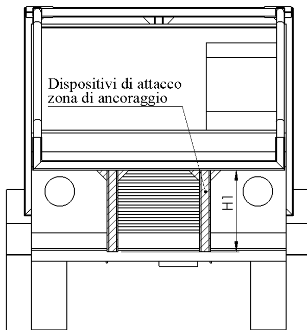
Figura 18. Zona di ancoraggio del dispositivo di attacco di classe D
